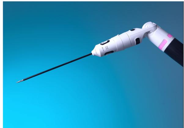
Gli strumenti Versius sono strumenti articolati (7 gradi di libertà) con uno stelo del diametro di 5,8 mm e una lunghezza di lavoro di 300 mm. Essi sono fissati ai bracci sulle unità chirurgiche Versius tramite un aggancio rapido
